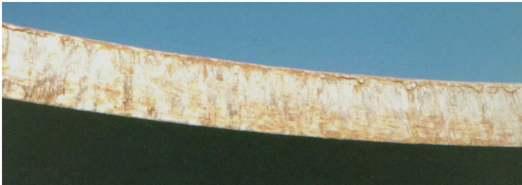
Abbildung 12. Beispiel einer Schnittkante eines reduzierten Trägerprofils
