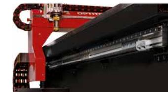
Die Zahnstangen sind nach unten gedreht und somit vollständig vor Spritzern geschützt.
